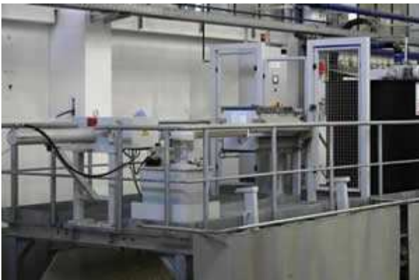
Bild 3: Stationäre Anlage zur Filtration von Schleifschlamm aus der Produktion von Betonfertigelementen Typ II
